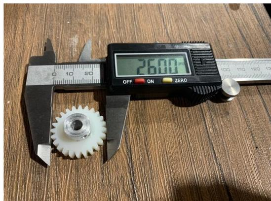
＜Zメカのアーム開閉モーター先端のギアです＞
